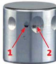
Deutlich: Ein Prüfzylinder aus dem Brugger-Test zeigt die unterschiedliche Schmierfähigkeit: Einen sehr guten Schmierstoff erkennt man an der kleinen Verschleißfläche (1), einen schlechteren an der großen Verschleißfläche (2)
