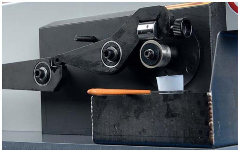
Test I: Das Testgerät „Triboproof T100“ ermittelt die Schmierfähigkeit in einem genormten Verfahren nach der DIN 51347
